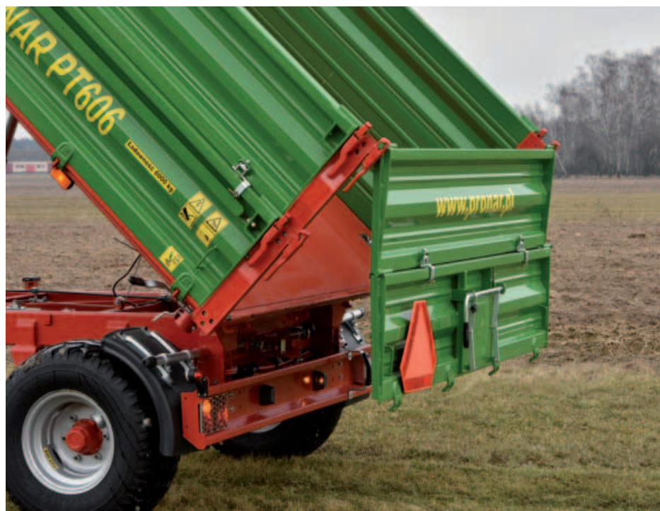
Szybr zsypowy w ścianie tylnej umożliwia nie tylko transport płodów i produktów rolnych, ale również materiałów budowlanych i różnych materiałów potrzebnych w pracach komunalnych
