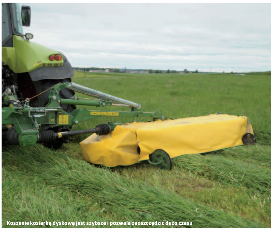
Pokos uzyskany kosiarką dyskową - w porównaniu do pokosu z kosiarki bębnowej - jest bardzo cienki i równomiernie rozłożony
