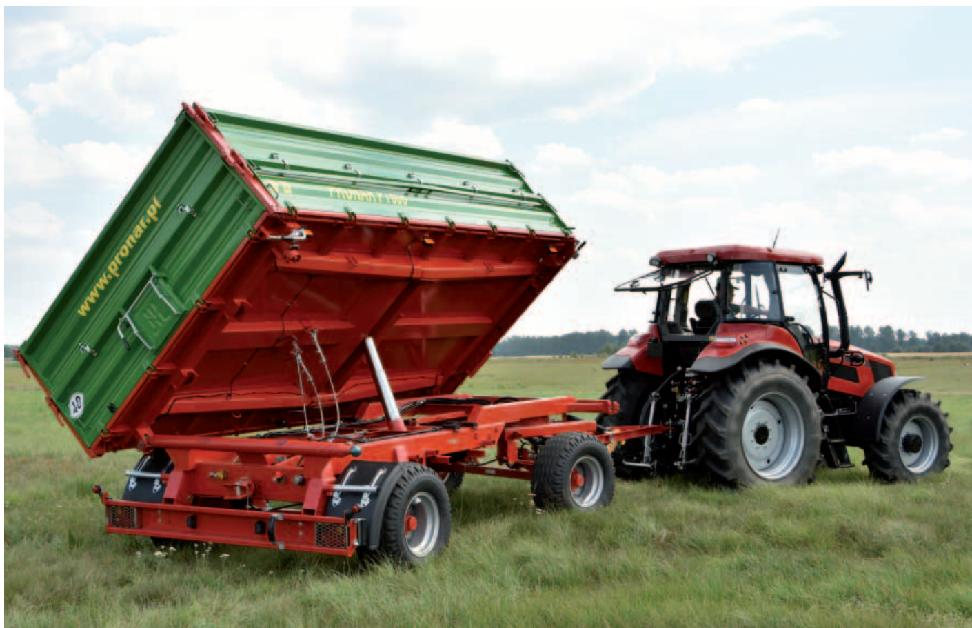
Przyczepa PRONAR PT608 jest wyposażona w mechanizm trójstronnego wywrotu
