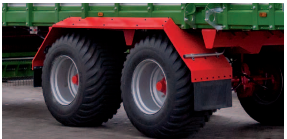
Tylna oś skrętna, stanowiąca wyposażenie standardowe, minimalizuje uszkodzenia darni oraz zużycie opon podczas jazdy po asfalcie
