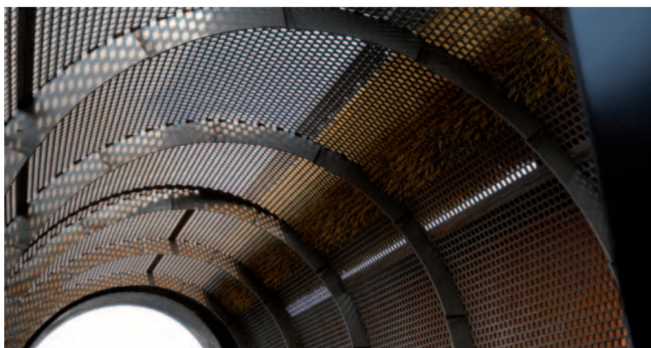
Bębny o grubości blachy 6 mm i wielkości oczka 40 mm - parametrach odpowiednich do przesiewania ziemi i odpadów organicznych wykorzystanych do produkcji kompostu
