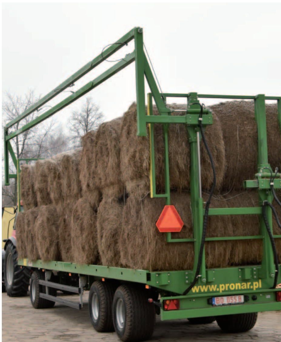
Hydraulicznie podnoszone i opuszczane ściany boczne (w wyposażeniu dodatkowym)
