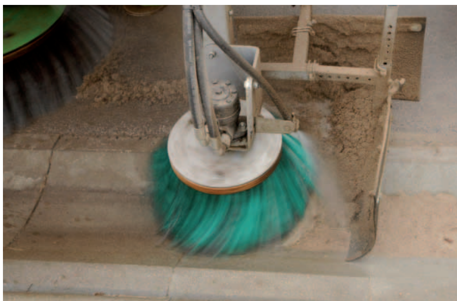
Szczotka boczna jest wyposażona w układ zraszania, który niweluje wzbijanie kurzu oraz w dwie ostony zapobiegające wyrzucaniu zamiatanego materiału poza obszar roboczy zmiatarki
