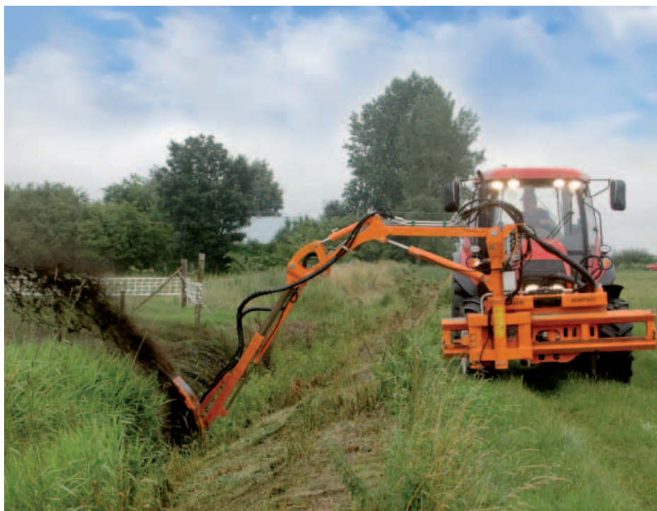
Głowica odmulająca PRONAR GO800 zagregowana z wysięgnikiem WWP600
