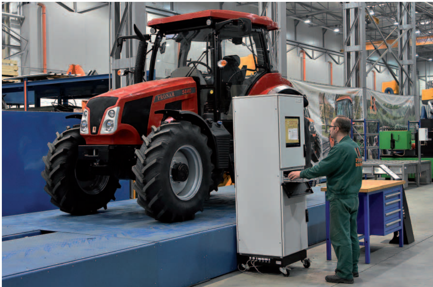
Prototyp nowego modelu ciągnika spełniającego wymogi norm Etapu IV – PRONAR 5440 - przechodzi testy stanowiskowe, eksploatacyjne oraz badania homologacyjne
