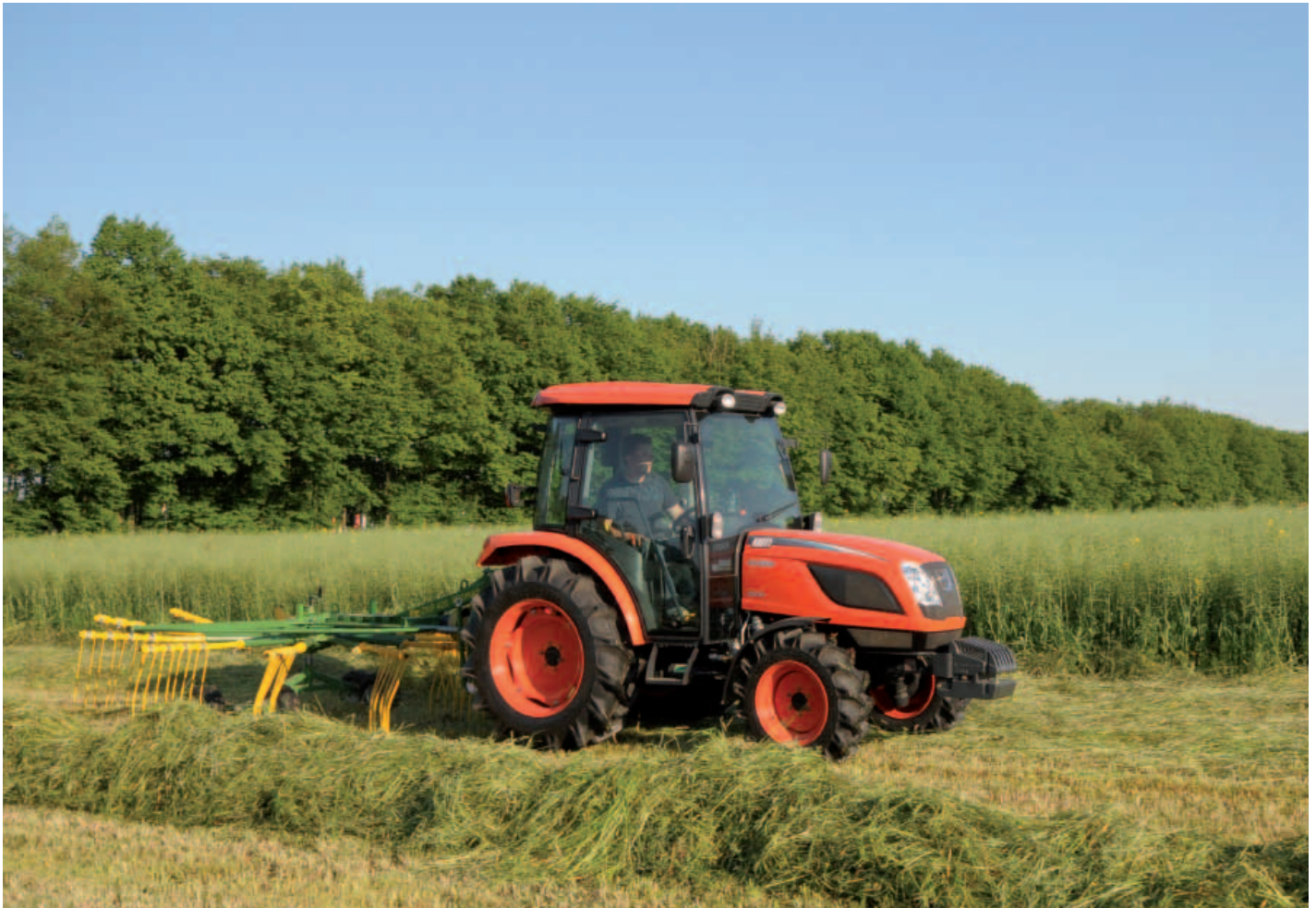
Udźwig tylnego trójpunktowego układu zawieszenia - wynoszący w osi końcówek 1605 kg - oraz niezależny hydrauliczny WOM pozwalają na przyłączenie większości potrzebnych urządzeń
