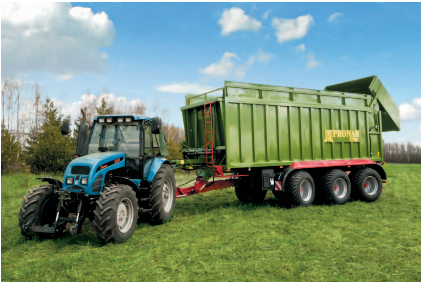
W przypadku przyczepy T900 istnieje możliwość uniesienia przedniej osi podczas jazdy bez ładunku
