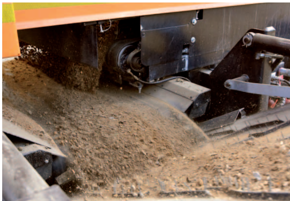
Przesiewanie wydobytej ziemi oczyszcza ją z zanieczyszczeń
