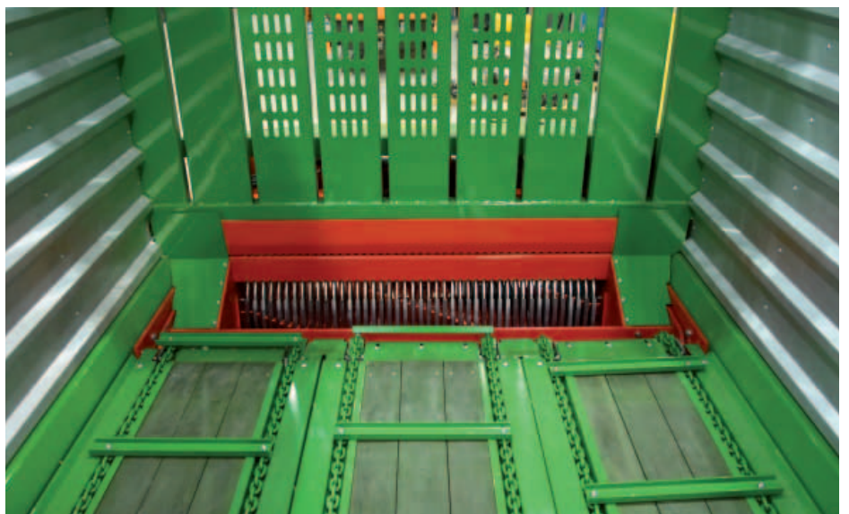
Rotor załadunkowy o średnicy 800 mm z ośmioma spiralnie ułożonymi rzędami ramion, wykonanymi z trudnościeralnej stali
