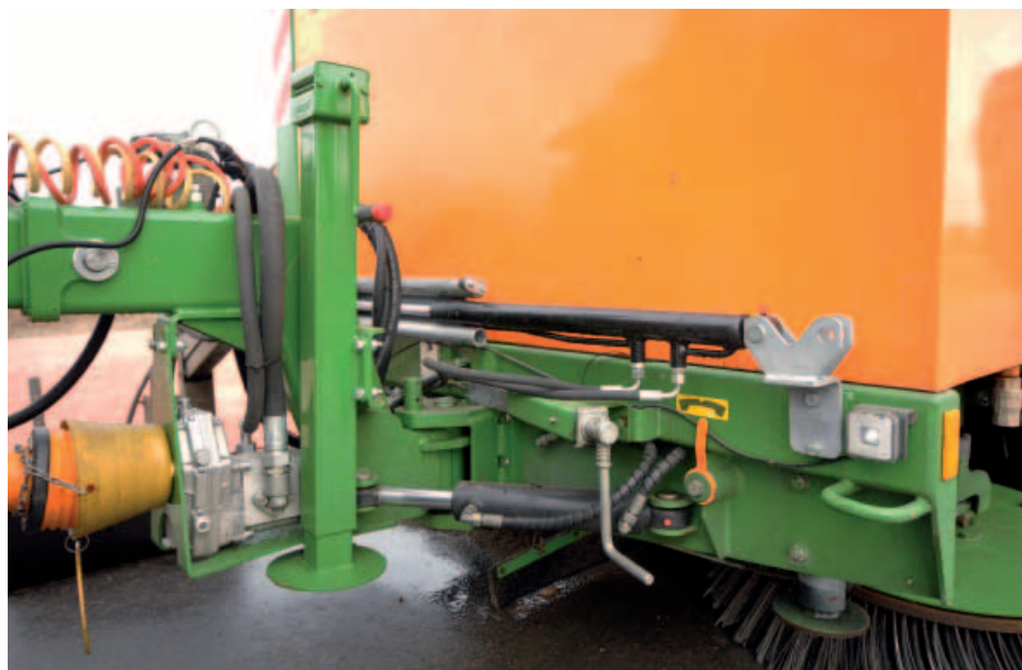
Rozwiązaniem zapewniającym możliwość agregowania zmiatarki z większą liczbą modeli ciągników jest wyposażenie jej w dyszel górny
