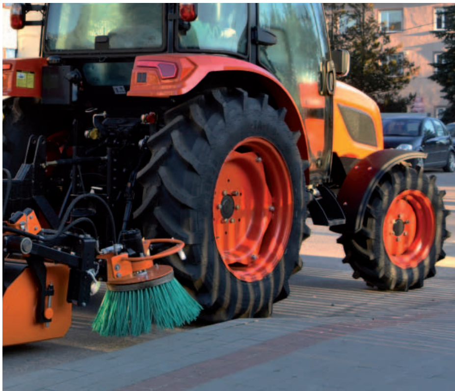
Dzięki użyciu szczotki bocznej, stanowiącej wyposażenie standardowe szerokość robocza może być zwiększona do 1650 cm
