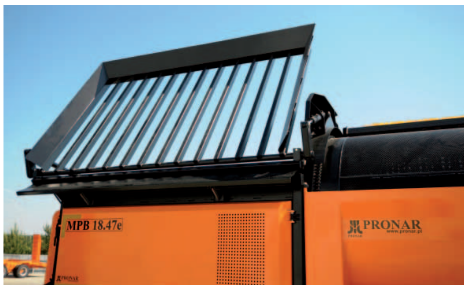
Krata nad koszem zasypowym zatrzymuje np. większe kawałki gruzu
