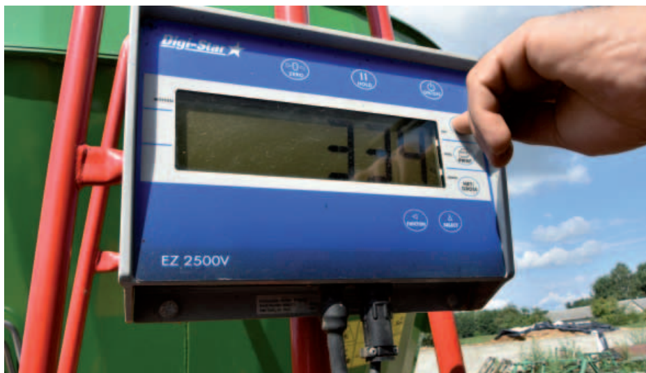
Czteropunktowy elektroniczny system wagowy
