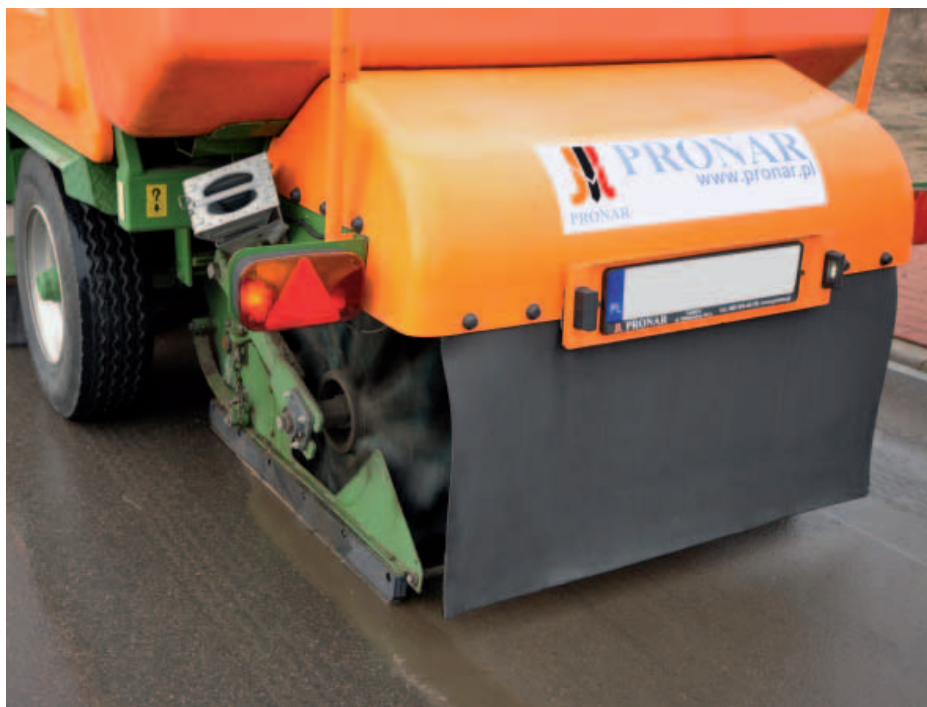
Zmiatarka ZMC 3.0 jest wyposażona w system zraszania
