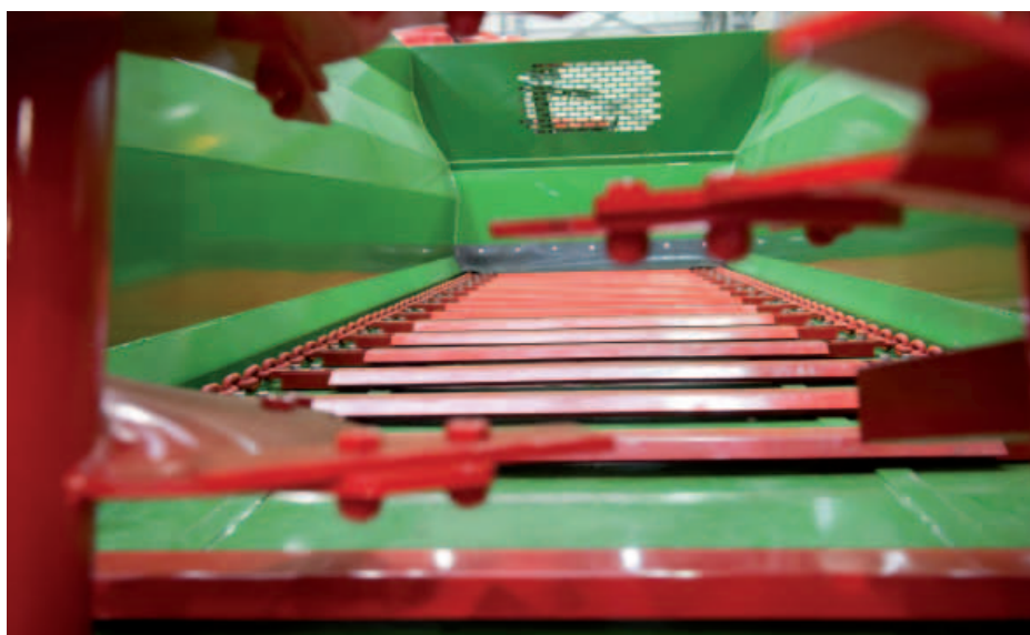
Przenośnik łańcuchowy z wysokogatunkowej stali z dwoma łańcuchami o grubości 14 mm i napędem hydraulicznym oraz z bezstopniową regulacją prędkości przesuwu
