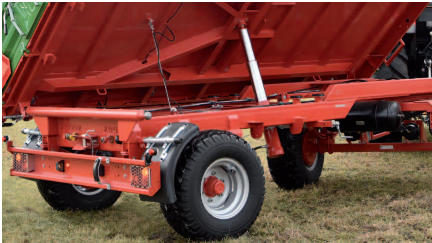
Rama podwozia PT606 jest spawana z prostokątnych zamkniętych profili ze stali konstrukcyjnej o wysokiej wytrzymałości
