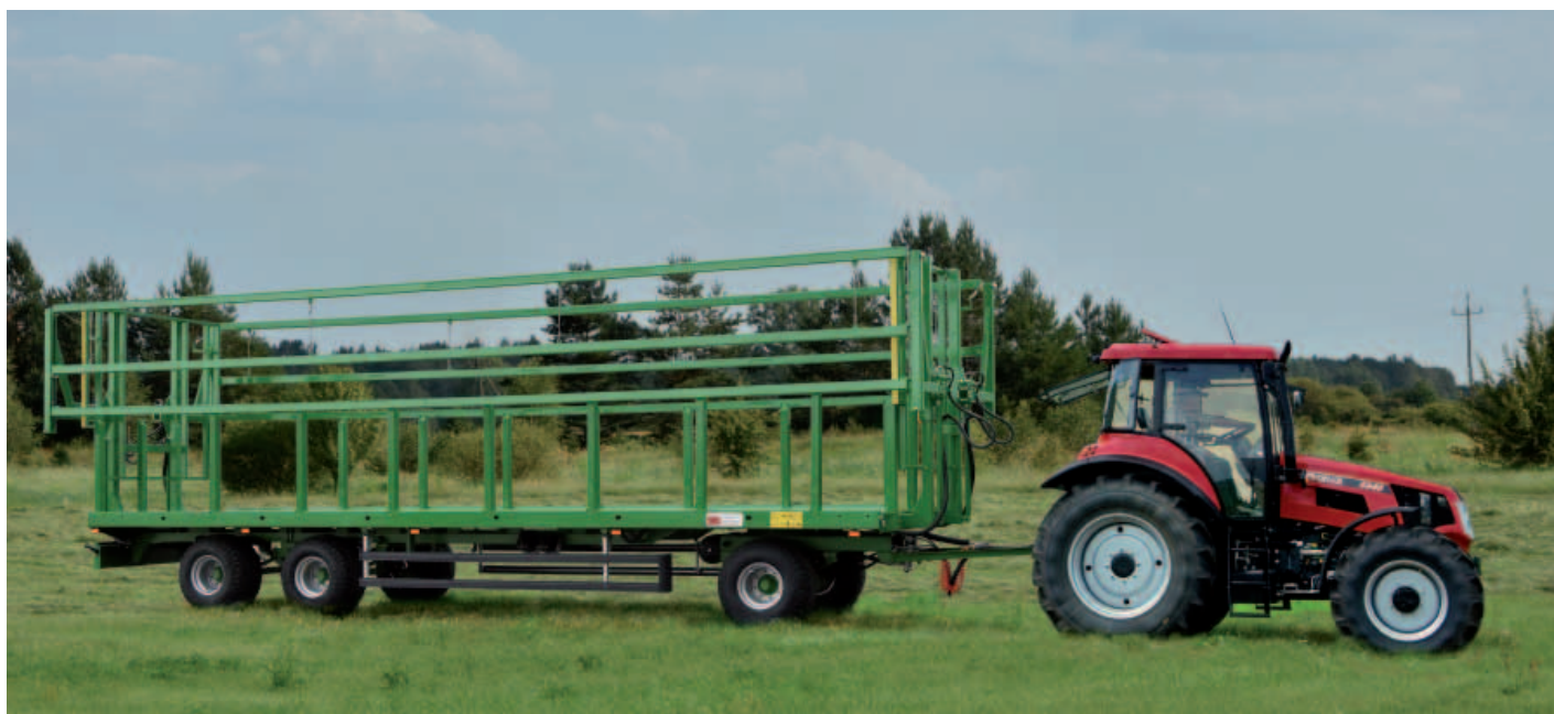
Hydraulicznie podnoszone i opuszczane ściany boczne (w wyposażeniu dodatkowym)
