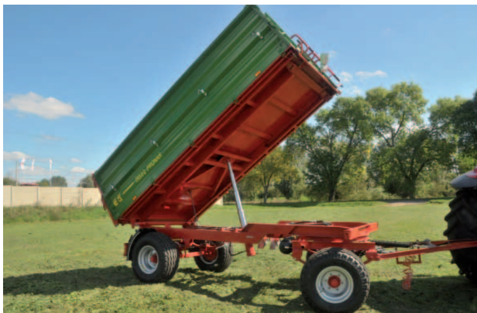
Funkcjonalność przyczepy PRONAR T653/2 zwiększa trójstronny wywrót skrzyni ładunkowej
