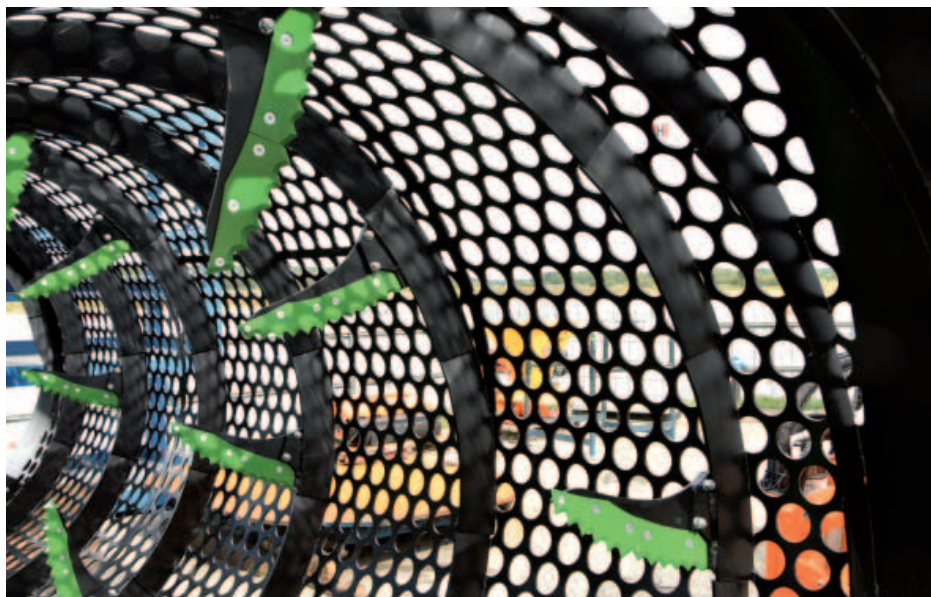
Bębny dostosowany do przesiewania odpadów komunalnych. Noże ułatwiają oddzielenie plastikowych toreb
