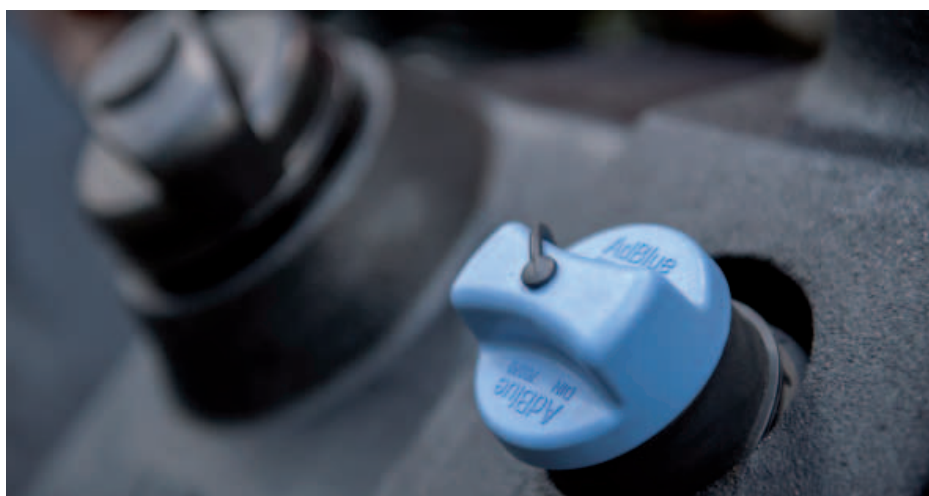
Roztwór AdBlue w dodatkowym zbiorniku wystarczy uzupełnić co około 2 tankowania
