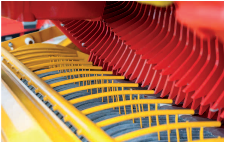
Podbieracz krzywkowy o szerokości 2 metrów bardzo podnosi wydajność
