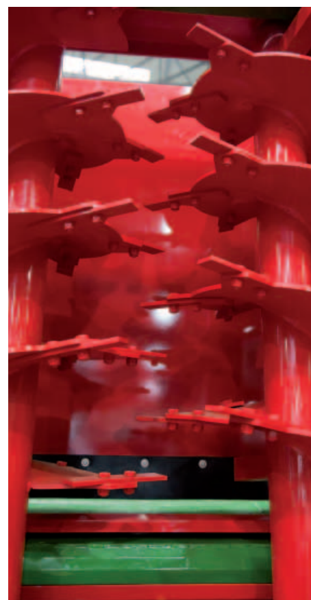
Adapter pionowy dwuwalcowy zapewnia szeroki i dokładny rozrzut oraz dużą wydajność
