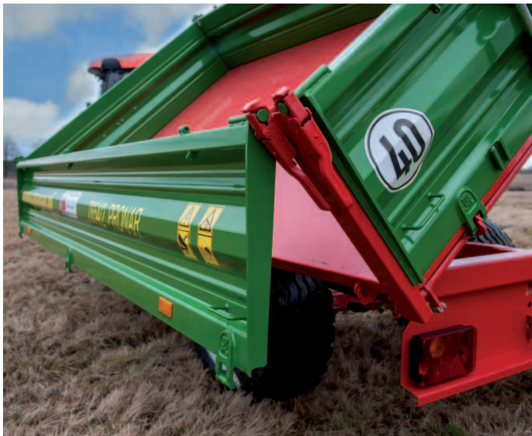
Trójstronny system wywrotu zapewnia duży komfort pracy
